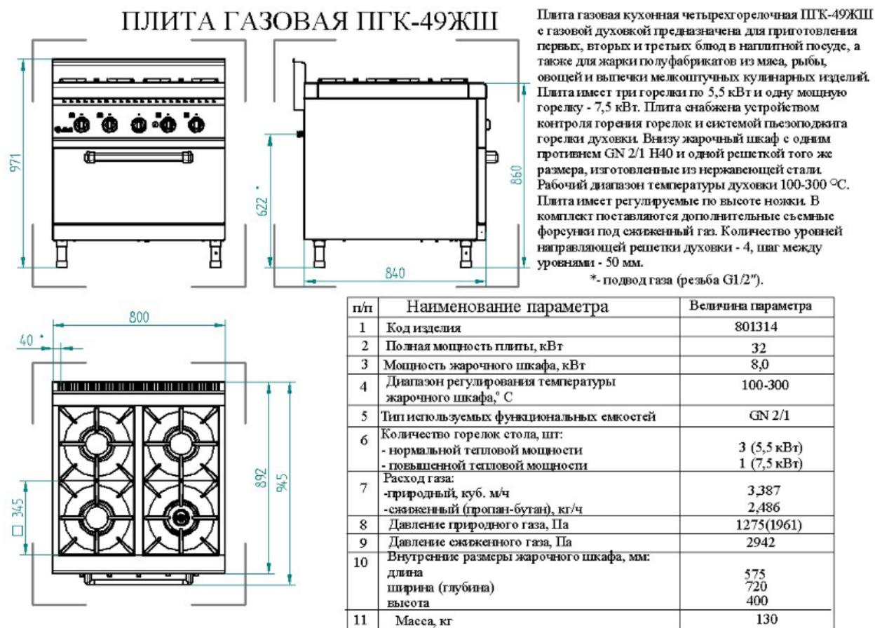
Рис.1 Технические характеристики газовой плиты
